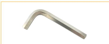
Sechskantschlüssel für Feuerweherschloss, Länge 170 mm, Chrom-Vanadium-Stahl, Revisions-schlüssel zur Betätigung der Schlauchanschlussarmatur DIN 14461-5, sowie zum Öffnen des Feuerweherschlosses DIN 14925 an Schranktüren für Löschwasser-Entnahme und Einspeiseeinrichtungen
