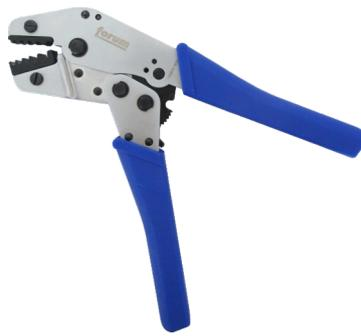
Für Aderendhülsen DIN 46228 (T. 1+4) mit und ohne Kunststoffkragen, Trapezpressung, Entriegelung in jeder Position möglich, stabile Ausführung
