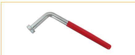
Schlüssel für Feuerweherschloss Din 14925, 130 mm, Stahl verzinkt, Griffstück polyolefin ummantelt, rot, Revisions-schlüssel zur Betätigung der Schlauchanschlussarmatur Din 14461-5, sowie zum Öffnen des Feuerweherschlosses DIN 14925 an Schranktüren für Löschwasser-Entnahme- und Einspeiseeinrichtungen
