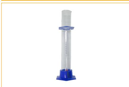
Zur Prüfung der Dichte von Flüssiglöschmitteln gem. der jeweiligen Instandhaltungsanleitungen, Höhe 300 mm, TP: 20°C inkl. Messzylinder 500
