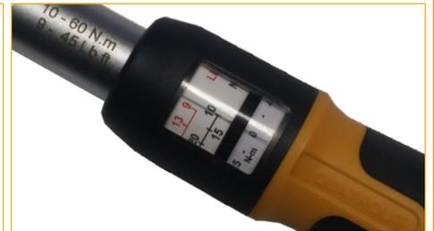
**Wichtiges Werkzeug zur Umsetzung der in den Instandhaltungsanweisungen angegebenen Drehmomente wie z.B. beim Anziehen der Jockey-Überwurfmutter der Armatur sowie des Schlauches.**
