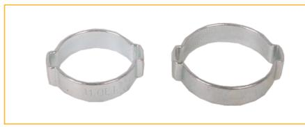
2-Ohr-Klemme aus Rohr, verzinktes Stahlband DIN 1.0338, Bandstärke: 1,50 mm, Bandbreite: 10,00 mm
