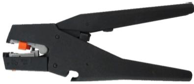
Zum Abisolieren (20 mm) und Schneiden von feindrähtigen und massiven Leitern mit PVC-Isolation und Mehrfachleitern. Keine Einstellung auf Leiterquerschnitt erforderlich, mit Längenanschlag. Die Messerkassetten sind austauschbar
