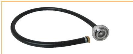
Für WHY Typ S Schlauchenngr. DN 25 (1"), Länge 1,6 m mit eingeb. Druck/Saugkupplung STORZ C u. 2/3 Schlauchtülle 1" IG, Stutzen 25 mm, flachd. bei Verwendung von Prüfpumpen mit Fass wie z.B. HPM, HPS13 oder Multipress
