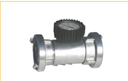
Manometer, gefüllt mit Glycerin, zur Fließ- und Ruhedruckmessung, 2xC Anschluss, 1x drehbar
