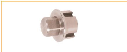
Montagenuss MN-MV-2-ZOLL zur leichteren Montageverschraubung C-2" DIN 14461-5 mit der Löschwasserleitung; Lösen bzw. Festziehen der Montageverschraubung C-2" ist mit handelsüblichen Steckschlüsseln, Umschaltknarren SW27 möglich. Durch universelle Fräsung für Fabrikate verschiedener Hersteller geeignet.
