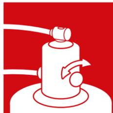
2. Bei den fahrbaren Flex-Geräten kann am Dosierrad der Mischkammer Trocken- oder Nassschaum eingestellt werden. Hierfür den Regler auf „dry“ oder „wet“ stellen.
