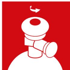
1. Den Schlauch knickfrei auslegen. Die Löschpistole in die Hand nehmen. Das Drehventil der Druckluftflasche vollständig aufdrehen. Die Druckluft geht sofort durch den Druckminderer und die Druckluftleitung in den Behälter. Das Löschmittel wird nun über das Steigrohr und die Mischkammer in den Schlauch gedrückt.
