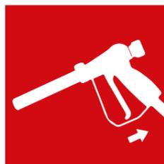
3. Die Löschpistole entsichern und auf den Brand richten. Über das Betätigen der Löschpistole kann das Löschmittel optimal dosiert werden. Feste und glutbildende Stoffe können mit kurzen Löschmittelstößen bekämpft werden. Flüssigkeitsbrände in einem Zug löschen.
